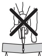
Wird die Klinge eingeklemmt oder bleibt sie im Rückschlagbereich stecken, kann die Heftigkeit der Rückschlageffekts zu heftigen Drehbewegungen und starkem Wackeln des Trennschleifers führen, was schwere oder tödliche Verletzungen verursachen kann. Auf mögliche Bewegungen des Werkstücks achten. Wenn das Werkstück nicht ausreichend gestützt ist und sich beim Schneiden verschiebt, kann es durch Einklemmen der Trennscheibe zu einem Rückschlag kommen.
