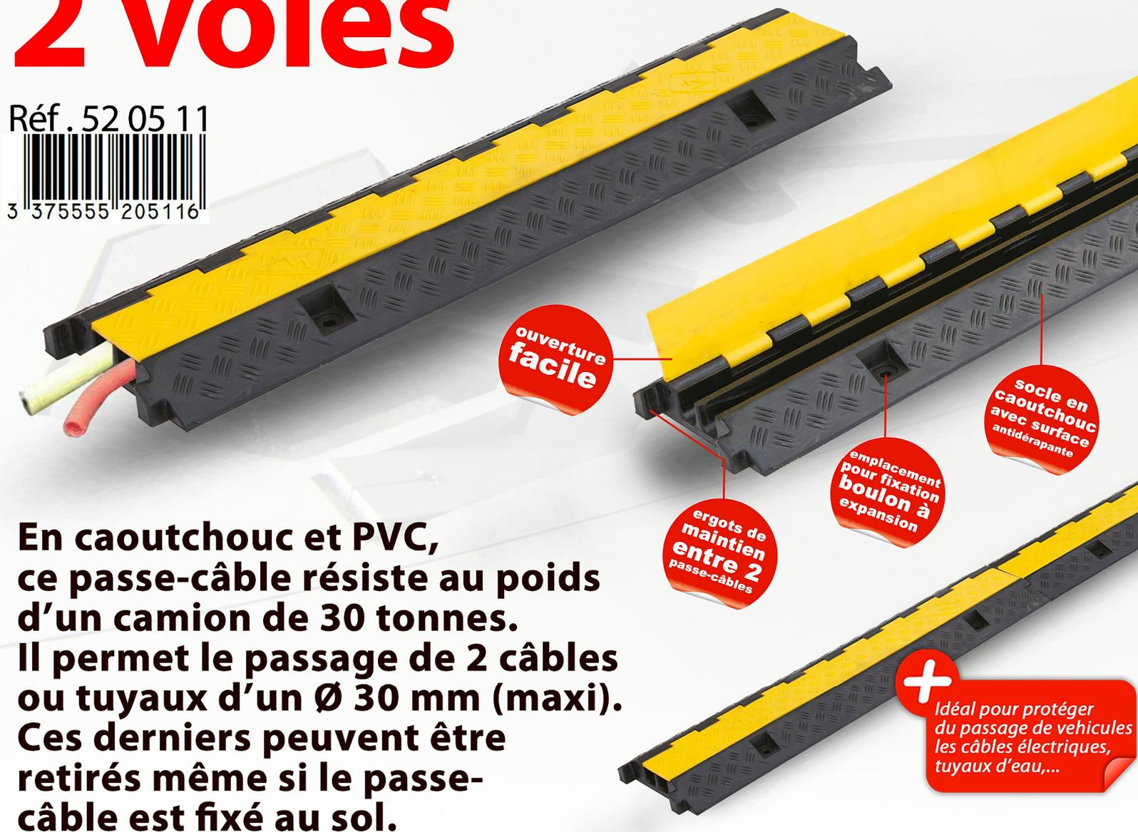
**En caoutchouc et PVC, ce passer-câble résiste au poids d'un camion de 30 tonnes. Il permet le passage de 2 câbles ou tuyaux d'un Ø 30 mm (maxi). Ces derniers peuvent être retirés même si le passer-câble est fixé au sol.**
